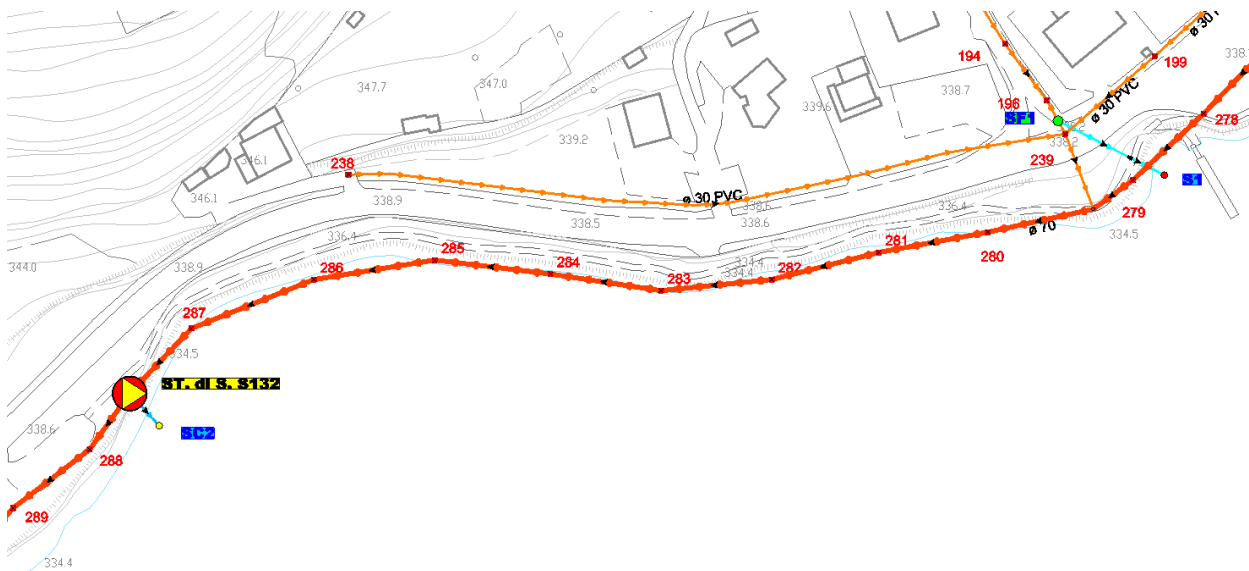
Figura 20 - Un tratto del collettore lungo la SS42 con l'impianto di sollevamento e lo sfioratore a lago
