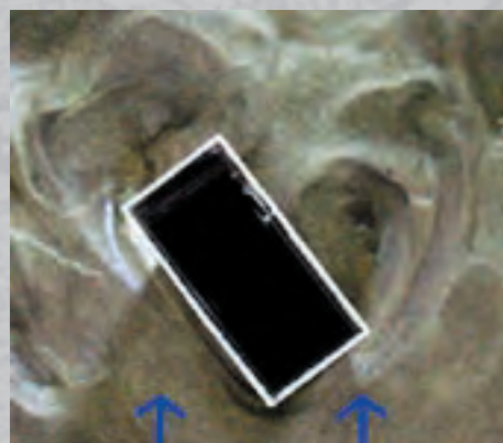
Vista dall'alto di un ostacolo rettangolare posto su fondo sabbioso in seguito a simulazione di piena: si vede l'erosione del suolo in prossimità degli angoli, le frecce blu indicano la direzione della corrente.
