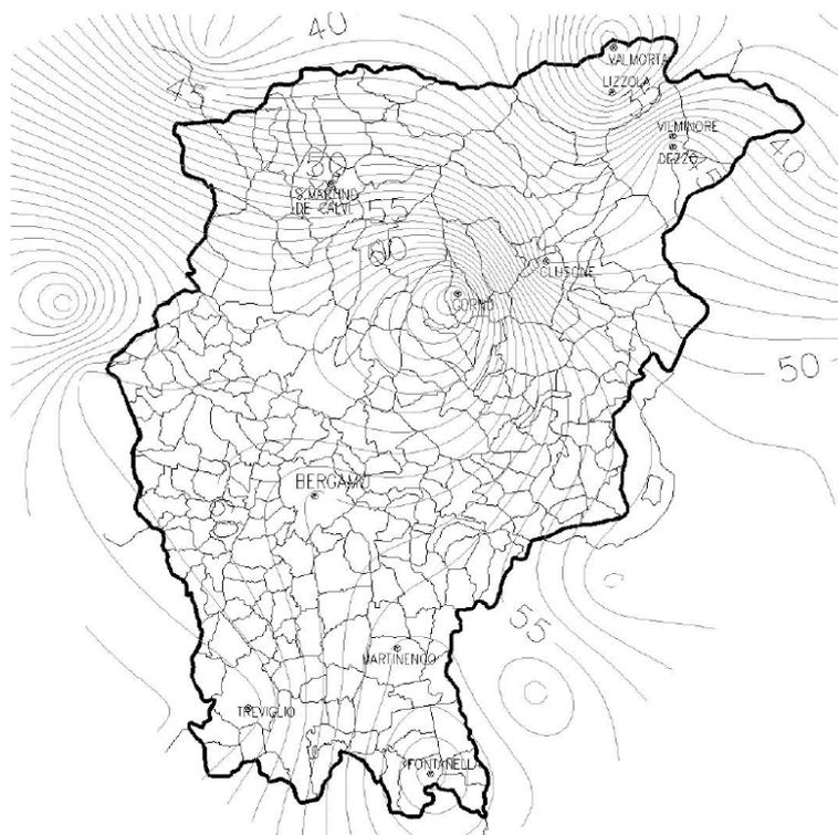
Figura 7.3n - Isolinee parametro n (T = 50 anni)
