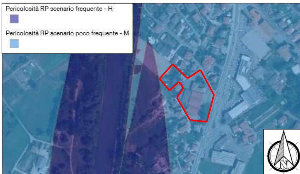
**Figura 4** Stralcio della cartografia ufficiale del Piano di Gestione Rischio Alluvioni (PGRA) tratta dal Geoportale della Regione Lombardia (SIT). La linea rossa mostra il perimetro del sito investigato che ricade in un'area di pericolosità poco frequenti (M – pericolosità P2) inerente al reticolo principale (RP), corrispondente alla fascia B del PAI.
