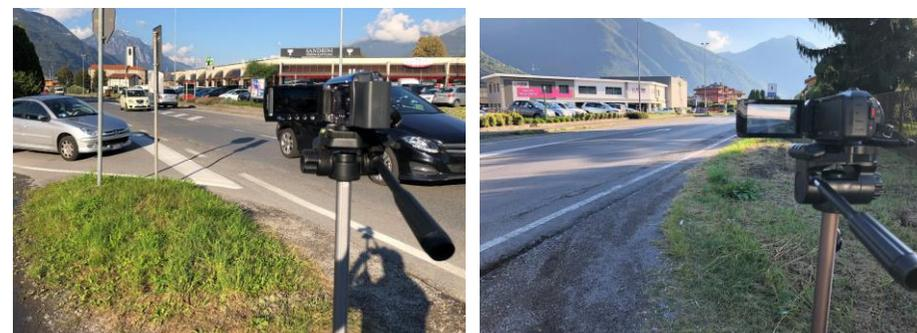
Figura 13 – Installazione delle postazioni di conteggio
